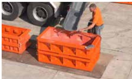
1 Coloque el molde sobre una placa de acero
