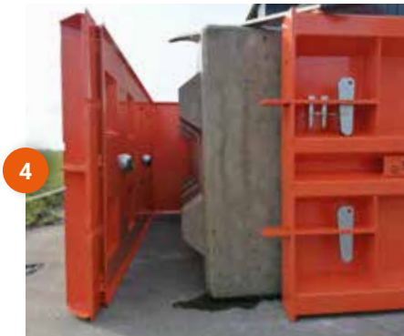
4 Cuando se abre el molde, el imán permanece en el molde
