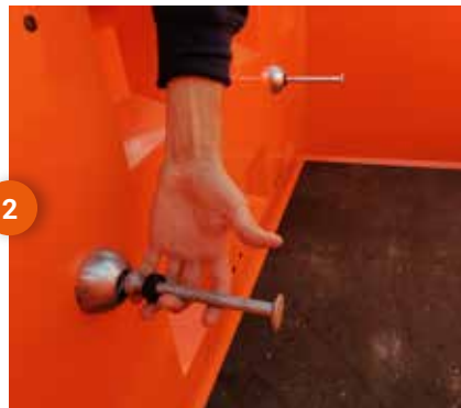
2 Coloque la arandela de goma (BBGR002) alrededor del perno de anclaje (BBHA025)
