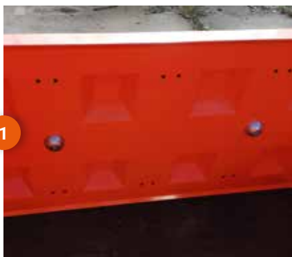
Placez le sphère magnétique (BBMAG02) au milieu du moule
