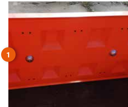
1 Posizionare il magnete (BBMAG02) al centro dello stampo
