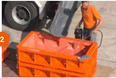
2 Applicazione del disarmante nello stampo
